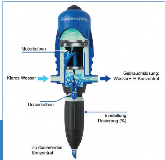
02 Schematischer Aufbau eines Dosatron-Proportionaldosierers
