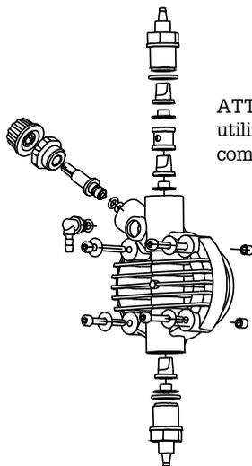
ATTENZIONE: per il serraggio delle quattro viti utilizzare un giravite dinamometrico, impostando come forza di serraggio  $1,8N \times m$ .
