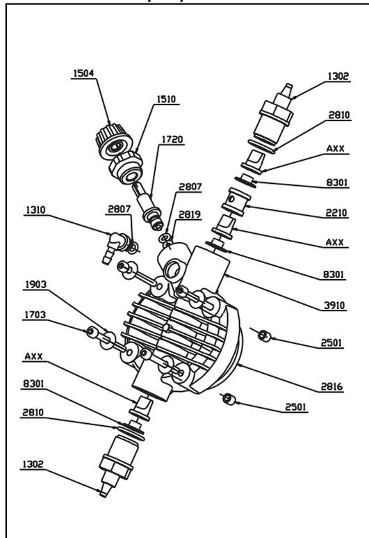
**Elettromagnete Completo - Complete Electromagnet**
