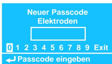
In diesem Menü können Sie den Zugangscode für das Menü „Elektroden“ einstellen bzw. ändern. Ab Werk ist der Wert „0 0 0 0“ (Default).
