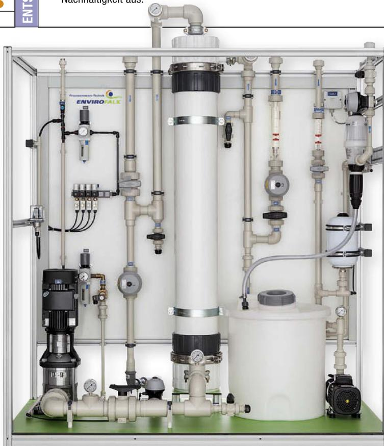
Beispiel einer Ultrafiltrationsanlage für die Metallindustrie.
