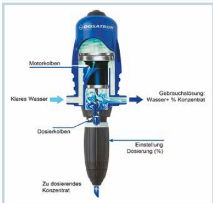
2 Ein Proportionaldosierer stellt unabhängig von Wasserdruck oder Zuleitungslänge stets die gewünschte Konzentration bereit
