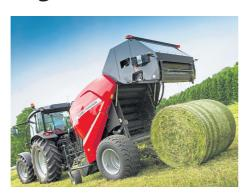
Sämtliche Maschinen verfügen über Merkmale, wie u. a. die Hochgeschwindigkeits-Pickup, das Antiblockiersystem Hydroflexcontrol, ein Konstantdrucksystem sowie das Xtracut-Schneidwerk und die Varionet-Netzbindung. Außerdem sind Optionen wie Druckluftbremse, breiterer Pickup und größerer Bereifung erhältlich.
