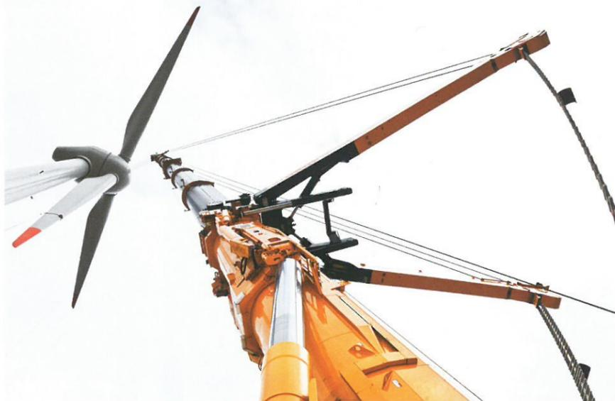
Teleskopzylinder an einem Mobilkran (unterer Bildteil)
