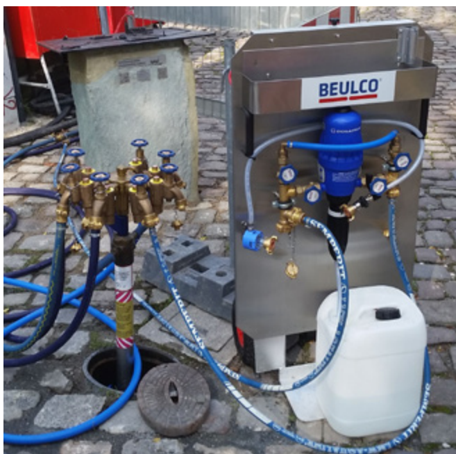
Bild 4: Mobile Reinigungs- und Desinfektionsanlage
